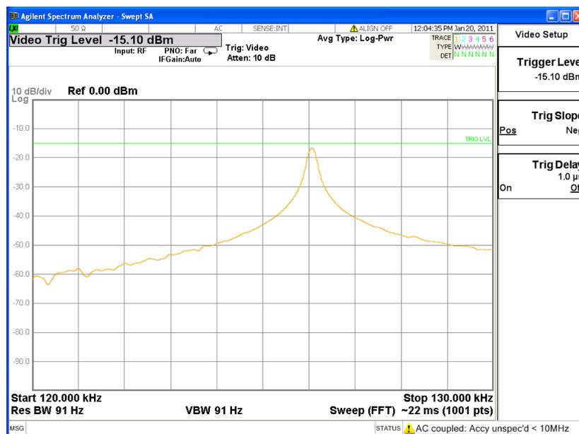
Après savoir l'intervalle de fréquence, on a utilisé la fonction de *Trigger Level* fixée à -15 dBm pour capturer l'image et remarquer et qui permettent de remarquer parfaitement la fréquence de travaille à 126 KHz..
